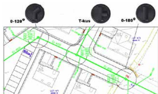
Příklady volby tvaru šachtového dna inspekční šachty AXEDO 600
