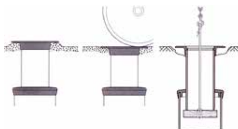
zhutnění povrchu vozovky
